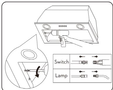
Зніміть фільтр і відкрутіть по 2 гвинти з лівого/правого боку панелі, від'єднайте лампу і роз'єм вимикача, а потім покладіть панель подалі. (як на малюнку)
